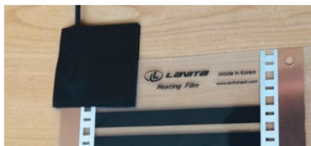
8 Фото после завершения подключения монтажных проводов.
