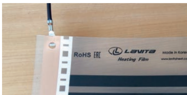
3 Вставьте наконечник между слоями пленки так, чтобы наконечник напрямую контактировал с медной шиной.
