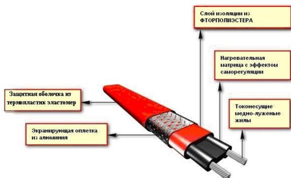
Кабель облужён для защиты от ультрафиолета при укладке на кровлю и желоба водостоков.
